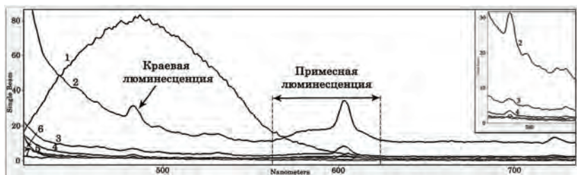
Рис. 1. Спектры флуоресценции при длине волны возбуждения 400 нм: 1 – суспензия расщепленного графита ультразвуком в смеси N -метилпирролидон + изопропиловый спирт, 2 – термически восстановленный ОГ, 3- водная суспензия ОГ, 4- ОГ на стекле, 5- стекло, 6 – смесь N -метилпирролидон + изопропиловый спирт, 7 – вода; На вставке изображены пики краевой люминесценции образцов ОГ.
