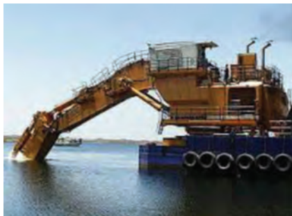
Рисунок 1. Плавающие экскаваторы используются для дноуглубления рек и водохранилищ.
