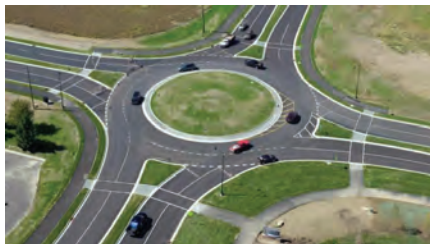
Рисунок 1 – Круглая форма центрального островка кольцевого пересечения
