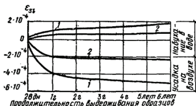
Рис. 2 Усадка и набухание: 1 – бетона, 2 – железобетона
