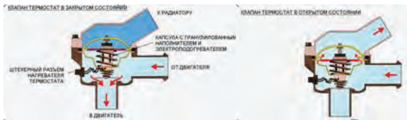
Рисунок 21 - 41: Электрическое регулирование клапаном – дросселем
