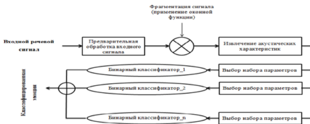
Рисунок 1 – Алгоритм работы автоматизированной системы распознавания эмоций по голосу
