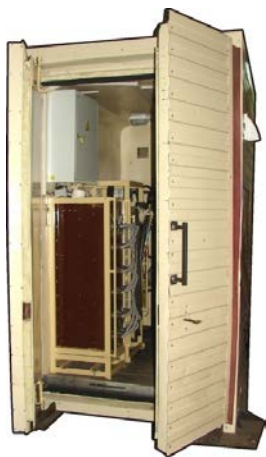
Рисунок 6 – Установка подготовки нефти малогабаритная
