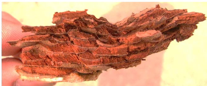
Рис.3. Вид получаемых под первым ротором отходов окорки
