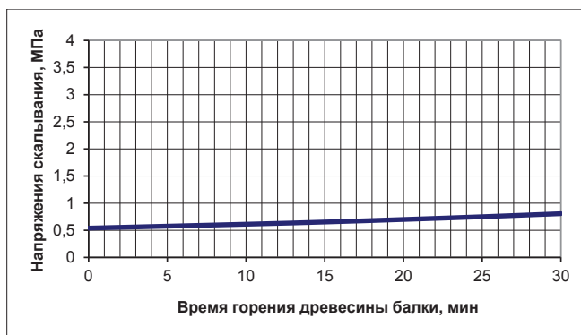
Рис. 2 График изменения напряжения скалывания \sigma_{fj}
