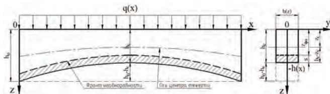
Рис. 2. Балка переменной толщины с односторонней неоднородностью
