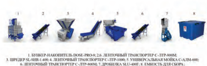
Рис. 2. Технологическая линия механического рециклинга
