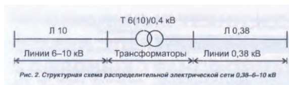
Рисунок 1– Структурная схема распределительной электрической сети 0,38 - 6 - 10 кВ
