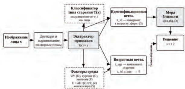
Рисунок 1. Архитектура метода идентификации с учётом типа старения и факторов внешней среды
