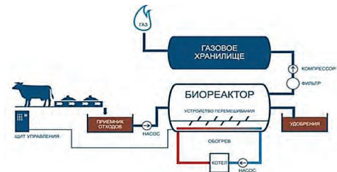
Рис. 1. Схема процесса получения биогаза из отходов животноводства
