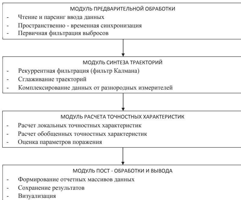
Рисунок 1. Структура модулей алгоритмической обработки данных
