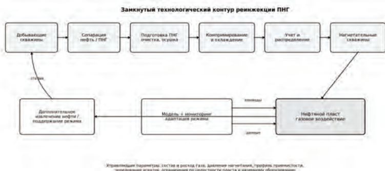
Рисунок 1 – Интеграция системы подготовки и закачки ПНГ в технологическую схему разработки
