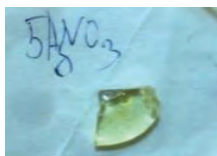
Рисунок 1 – Образец №1 оксифторидное стекло с молекулярными кластерами серебра.
