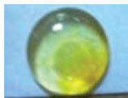
Рисунок 2 – Образец №2 оксифторидное стекло с молекулярными кластерами серебра и ионами самария.
