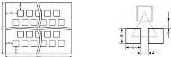
Рисунок 1. Основные размеры заготовки и перфорации
