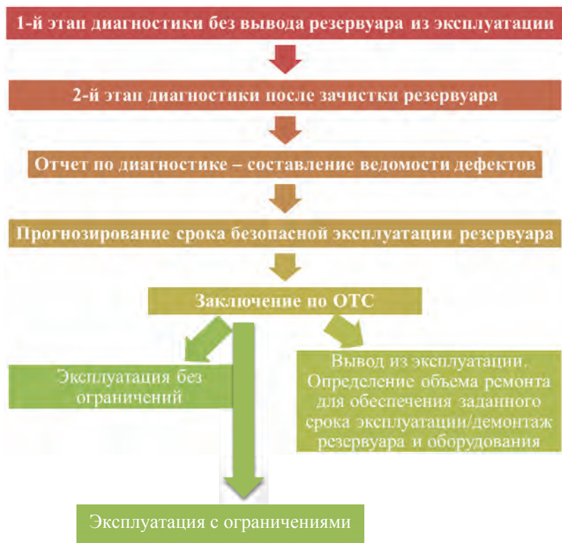
Рис. 1. Схема выполнения работ по ОТС резервуаров
