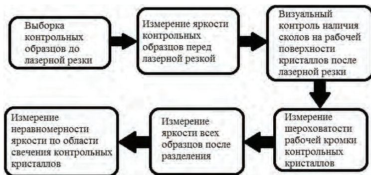
Рис.6. Система контроля качества кристаллов с ОСИД после лазерной резки
