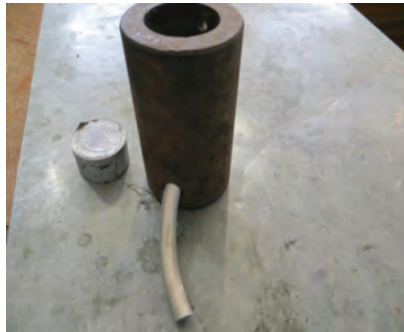
Рис. 2 - Контейнер, прессованный пруток и пресс - остаток
