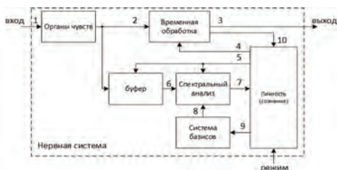
Рис. 1. Схема модели обработки сигналов: 1 - данные; 2 - сигналы; 3 – выходной сигнал; 4 – управление импульсной характеристикой; 5 – управление работой буфера и спектральным анализом; 6 – сигнал для спектрального анализа; 7 – спектр; 8 – система базисов; 9 – управление системой базисов; 10 – первичная обработка временных данных (корреляционная обработка)
