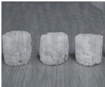
Рисунок 1. Образцы монтажной пены до испытаний
