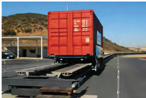
Рисунок 1. Транспортная грузовая платформа на магнитном подвесе фирмы General Atomics. США
