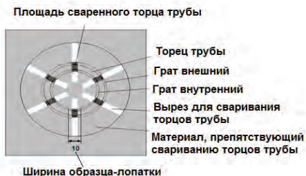
Рисунок 1. Шаблон для получения заданной области сварки в сварном стыковом соединении полимерных труб
