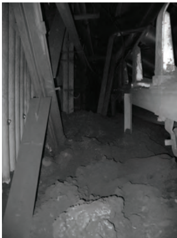
Рисунок 2 – Просыпь угля на галерее
