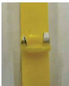
Рисунок 3. Образец-лопатка сварного соединения с заданной областью сварки
