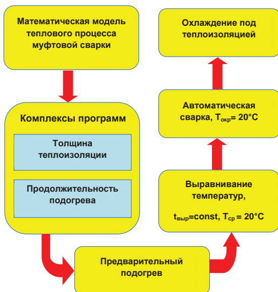
Рис. 1. Схема технологии муфтовой сварки полиэтиленовых труб при температурах воздуха ниже нормативных
