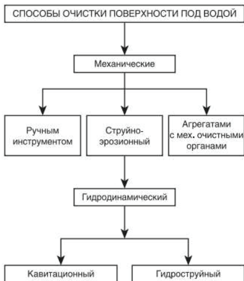
Рисунок 2 – Основные способы очистки поверхностей под водой
